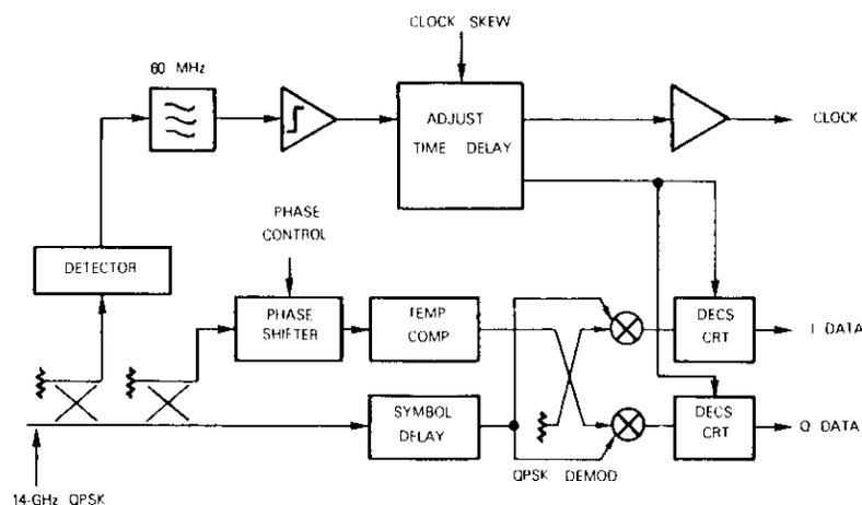
Figure 7. Block Diagram of the DQPSK Receiver
