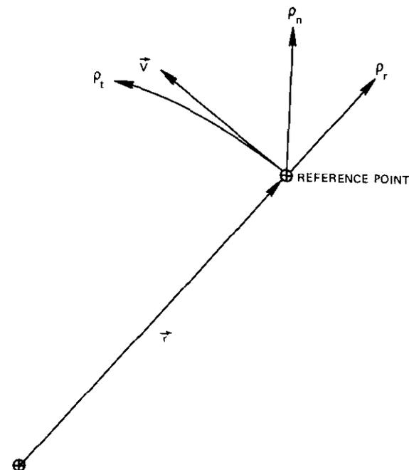
Figure 4. Nomenclature for Longitudinal Drift Analysis
